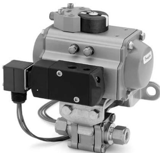
带尺寸符合 ISO 5211 的执行机构, ASCO® 电磁阀和 Pepperl+Fuchs 接近开关的世伟洛克 63 系列阀门。
